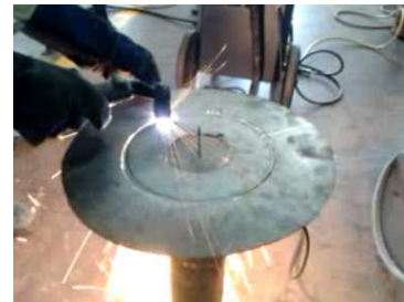
Gambar 3. Pemotongan bakalan satu kisar sudu.
