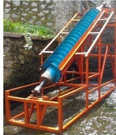
Gambar 11. Hasil pembuatan turbin ulir Archimedes.
