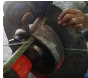
Gambar 4. Pembentukan dan pengelasan sudu ulir.
